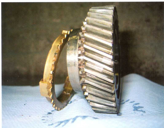
Een tandwiel met een conische synchroneshring nog gemonteerd en een tandring reeds losgemaakt.
