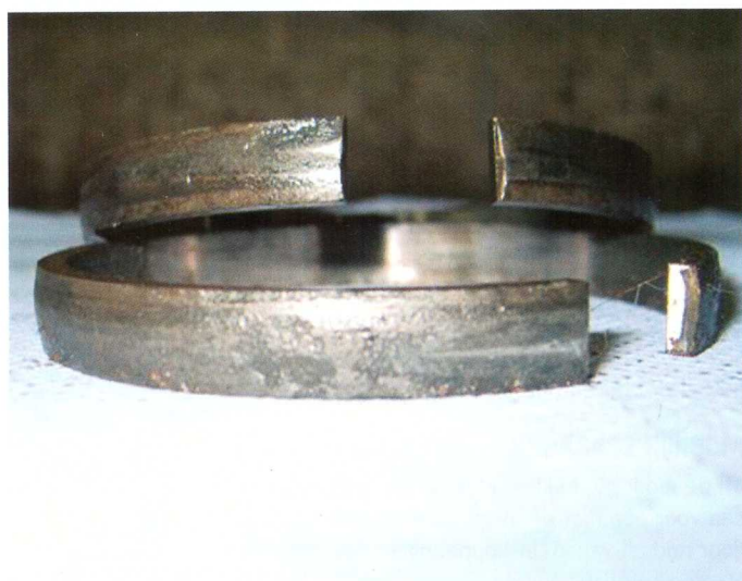
Twee versleten conische synchroneshringen, te herkennen aan het gladde, glimmende oppervlak.
