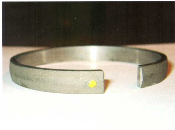
Een nieuwe conische synchroneshring met een regelmatig, ruw oppervlak.
