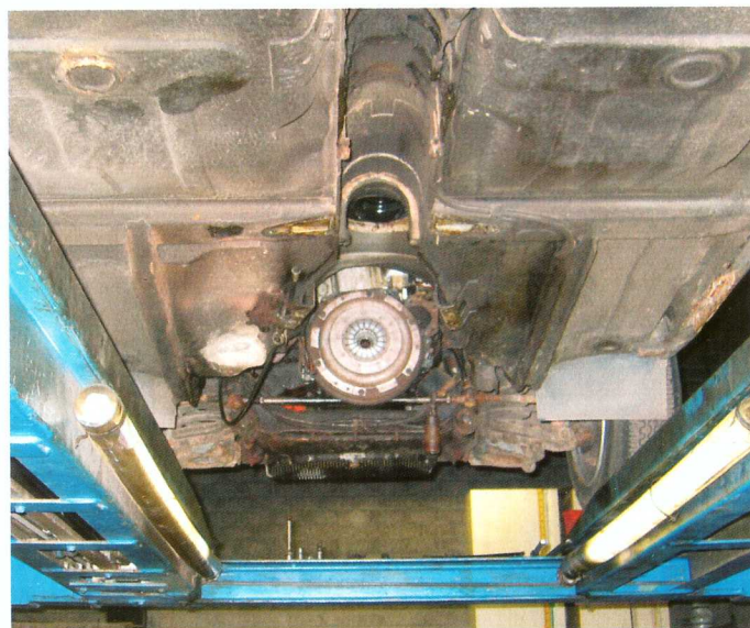
We kijken hier tegen de koppelingsplaat aan van onze Alfa 1750 Berlina. De versnellingsbak is gedemonteerd.
