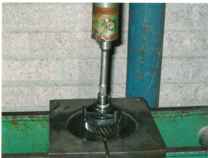
Een pers is onontbeerlijk om de tandwielen, synchroneshes en schakelmoffen te scheiden van de as.
