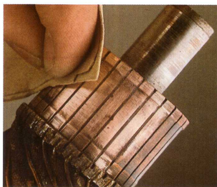
2 | Commutator gladmaken met fijn glaspapier
