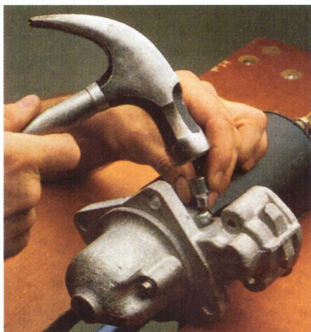
De scharnieren van de hefboom moet door de bedieningsvork gaan.
