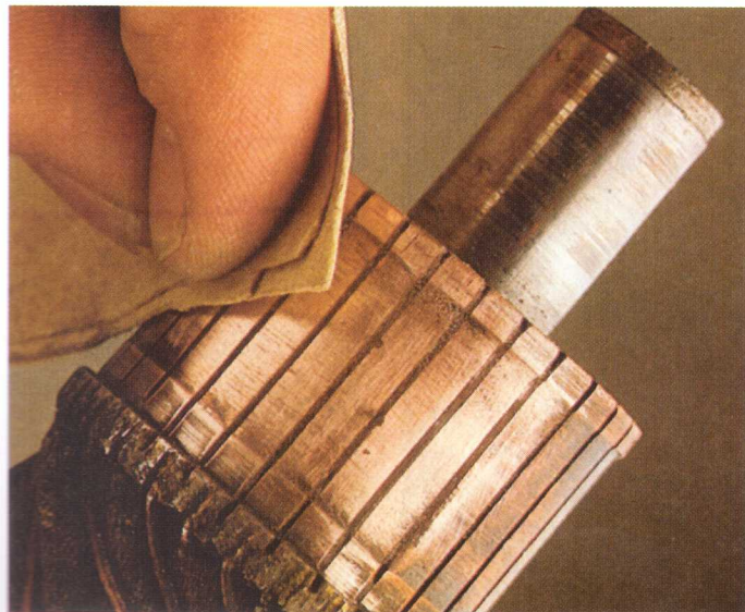
Een licht ingebrande commutator (trommeltype) kan met heel fijn glaspapier opgeschuurd worden.
