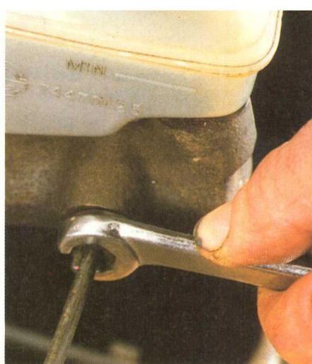
Gebruik bij het losmaken van de remleidingen een sleutel die goed op de wartelmoeren past, om te voorkomen dat u ze beschadigt.
