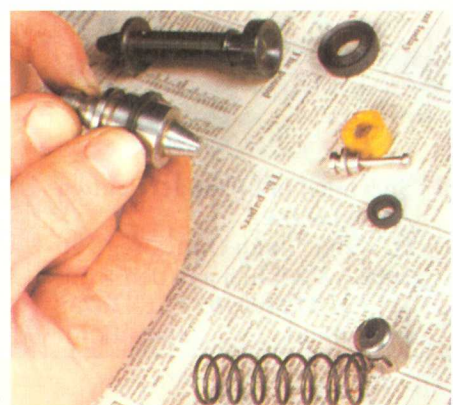
Een reparatiesetje voor de hoofdremcilinder, dat bestaat uit nieuwe cups, afdichtingen en een kantelklep.
