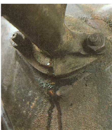
Als er rond de verbinding tussen hoofdremcilinder en de rembekrachtiger vloeistof naar buiten komt, kan de hoofdremcilinder lekken.
