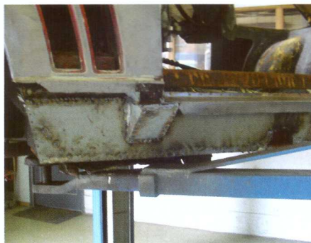
13. Na de nodige uren meten, knippen, passen en lassen ziet het er weer beter uit dan nieuw.
