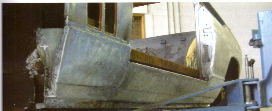
14. Kijk, zo hoort 't! De dorpel keurig dicht en strak.
