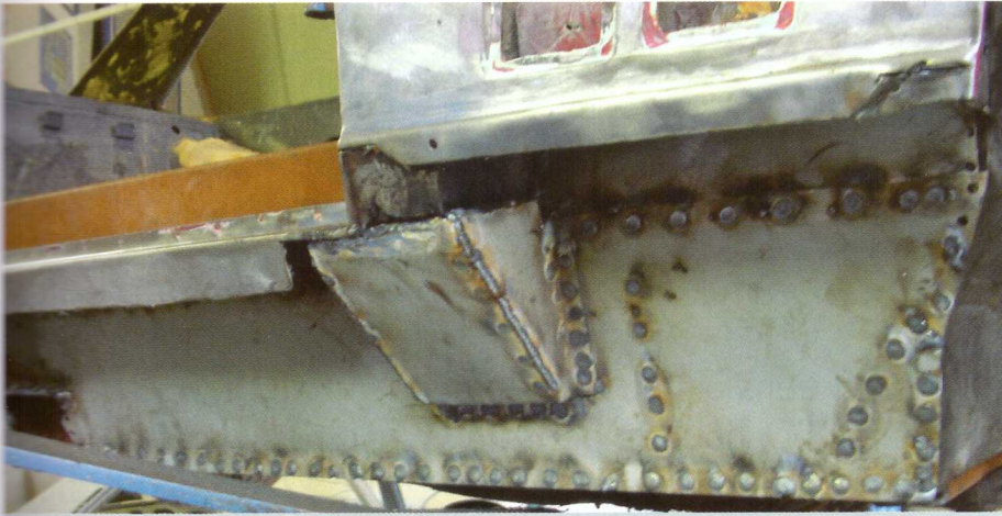
7. De versteviging onder de A-stijl wordt weer in ere hersteld. Op foto 2 is te zien wat er nog van over was. Nu beter en steviger dan toen de Lele de fabriek verliet.
