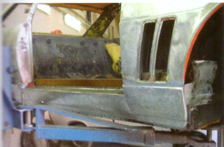
9. De rechter dorpel weer netjes dicht. Tevens is het nieuwe stuk in de wielkast zichtbaar. Het opsplattend vuil had door de jaren heen zijn vernietigende werking gedaan en dus... nieuw stukje erin!
