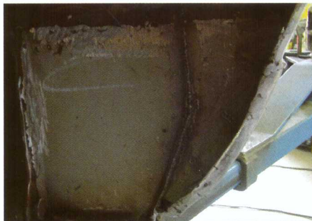
10. In de wielkast rechts achter is een nieuw stuk gelast, dit vormt tevens het uiteinde van de dorpel. N.B. De lasnaden worden later afgewerkt met primer en afgekit.
