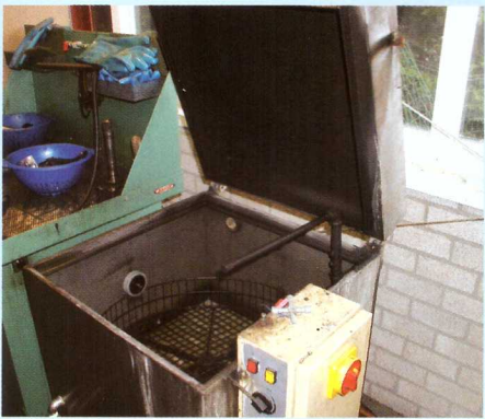
De wasmachine waarin de bakken worden gereinigd
