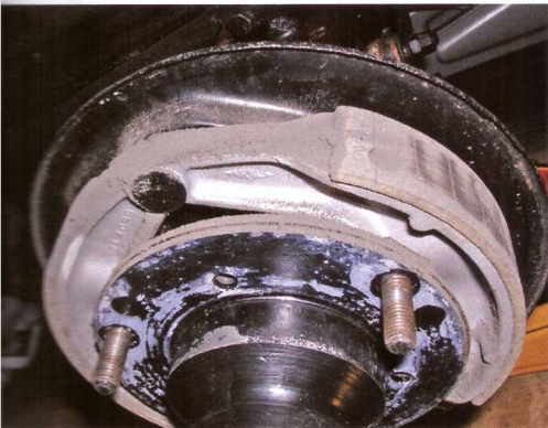
... en het stoffige resultaat na een kwartiertje zachtjes remmend draaien aan de trommel
