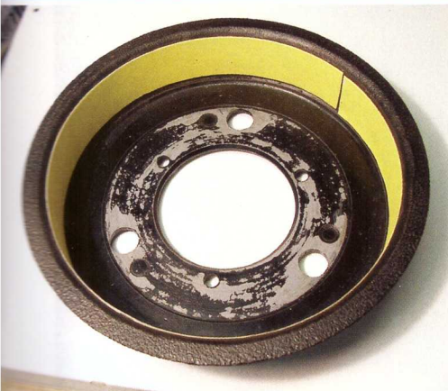
Het laten paslopen met strips schuurlijnen in de trommels...
