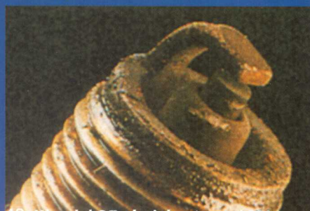
Bougie met roetaanslag: het brandstofluchtmengsel is te rijk.
