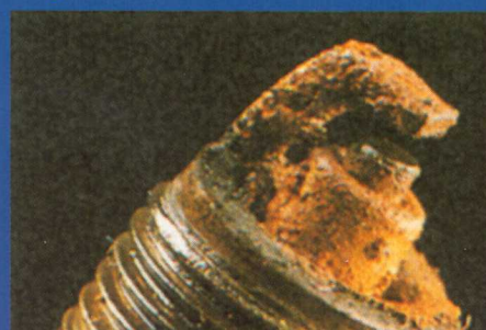
Lichtbruin of bijna wit aangeslagen bougie: het mengsel is te arm.
