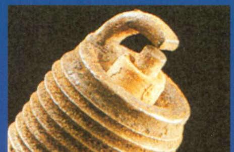
Een bruine, vastgekoekte aanslag op de elektroden: brandstof met een te laag octaangetal.
