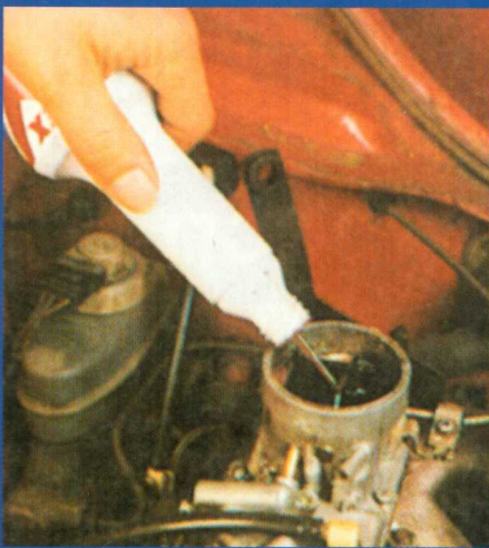
Het ontkoolmiddel kan bij draaiende motor via de carburateur worden toegediend. Verhoog het toerental gelijktijdig, anders slaat de motor af.
