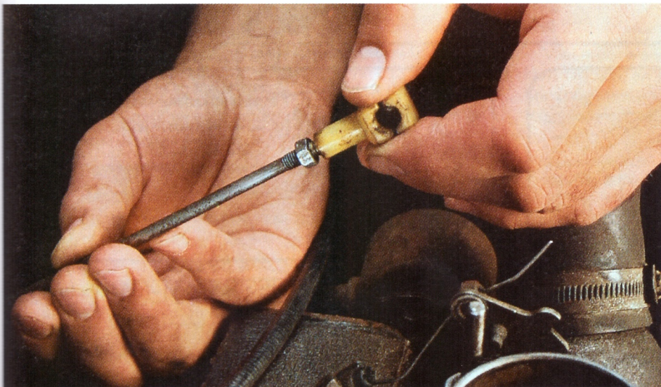
19. Draai borgmoeren los, trek kogelgewrichten uit elkaar en verstel ze door ze te verdraaien
