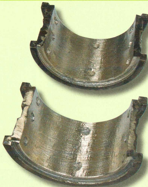
Na het handfreesen lekker schoon brons.
