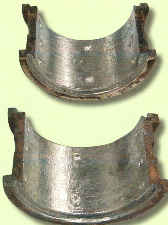
De babbits is losgelaten van de bronzen onderlaag.
