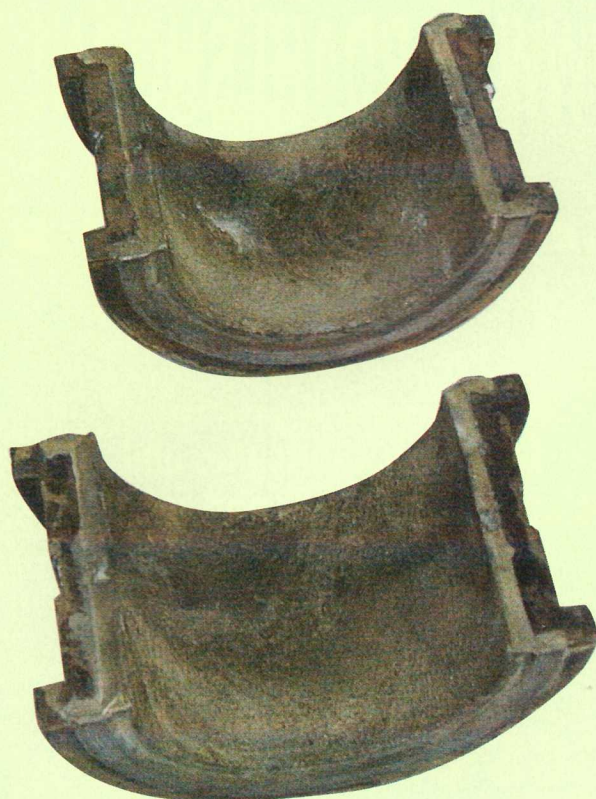
Vervuiling in de gietmallen.
