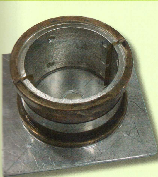
Gietmal van aluminium, en de bronzen lagere.
