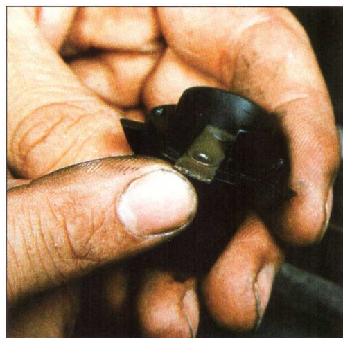
2. Metalen punt van rotorarm moet blank gehouden worden
