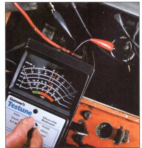
17. Contacthoek verdeler meten met testapparatuur
