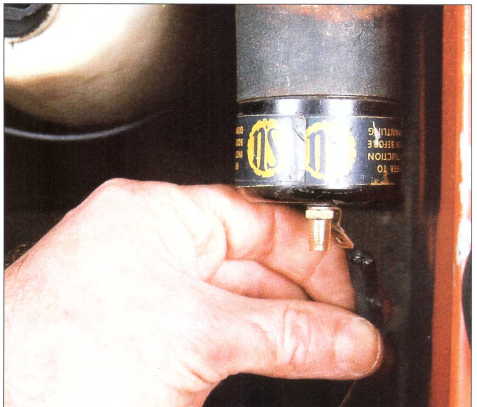
6. Zorg dat elektrische aansluitingen goed vastzitten
